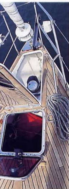
LA BAILLE À MOUILLAGE est à revoir car elle se bloque sur le tambour d'enrouleur.
