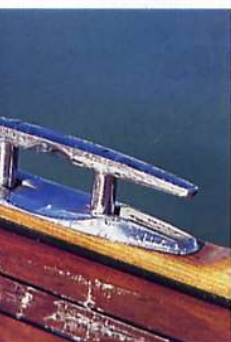
LES TAQUETS D'AMARRAGE en inox s'escamotent en mer.
